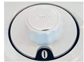
FLOW RATE SELECTOR KNOB Untuk mengatur flow oksigen.
